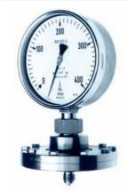
**Messflansch:** Anzeigebereiche ≤ 250 mbar = Ø 160 mm, Anzeigebereiche ≥ 400 mbar = Ø 100 mm, oberer Messflansch CrNi-Stahl 1.4301
